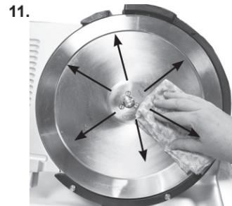
11. Lavare con attenzione la parte superiore e inferiore della lama pulendo dal **centro della lama verso l'esterno**.
